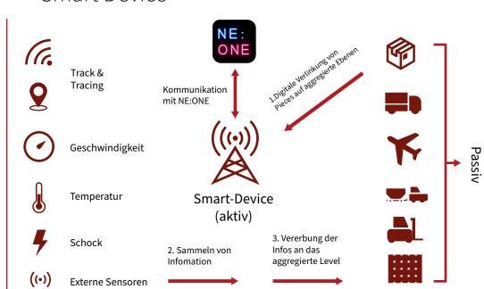
Das Smart-Device verbindet über aktive und passive Beacons die Struktur verschiedener Objekte aus der Realität und überträgt diese in die One Record Datenstruktur. Dadurch lassen sich Frachtdaten, wie die aktuelle Position automatisch auf eine große Anzahl an Sendungen übertragen und aktiv teilen.
